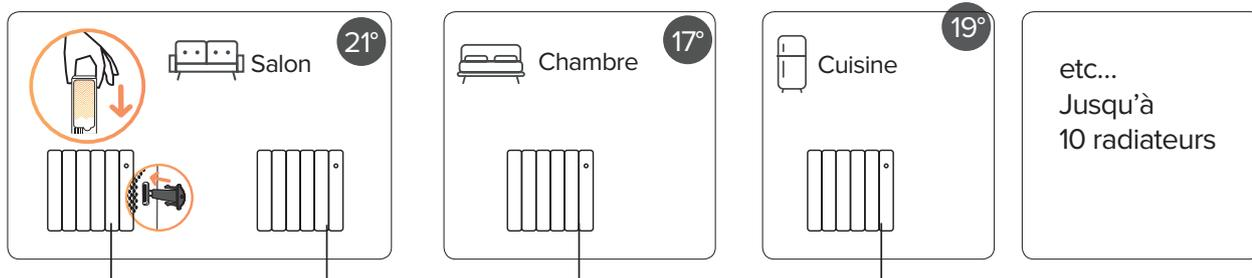
Le câblage de l'installation comporte un fil pilote permettant de raccorder tous les radiateurs.
