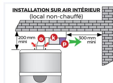
PLUSIEURS TUBES DE PVC ORDINAIRES SONT NÉCESSAIRES POUR COMPLÉTER L'INSTALLATION : (K) TUBE PVC ø 80 (TUBE CENTRAL), (L) TUBE PVC ø 125 (TRAVERSÉE DE MUR), (O) COUDE PVC ø 80 F/F (SORTIE SUR AIR INTÉRIEUR)
